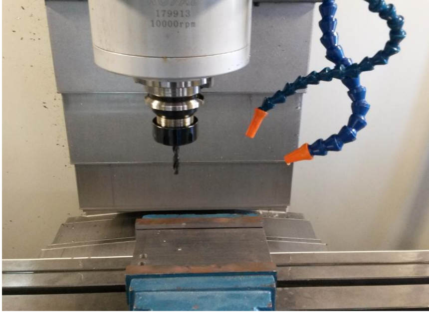
Şekil 1. Delik Delme İşleminin Yapıldığı Deney Düzeneği
